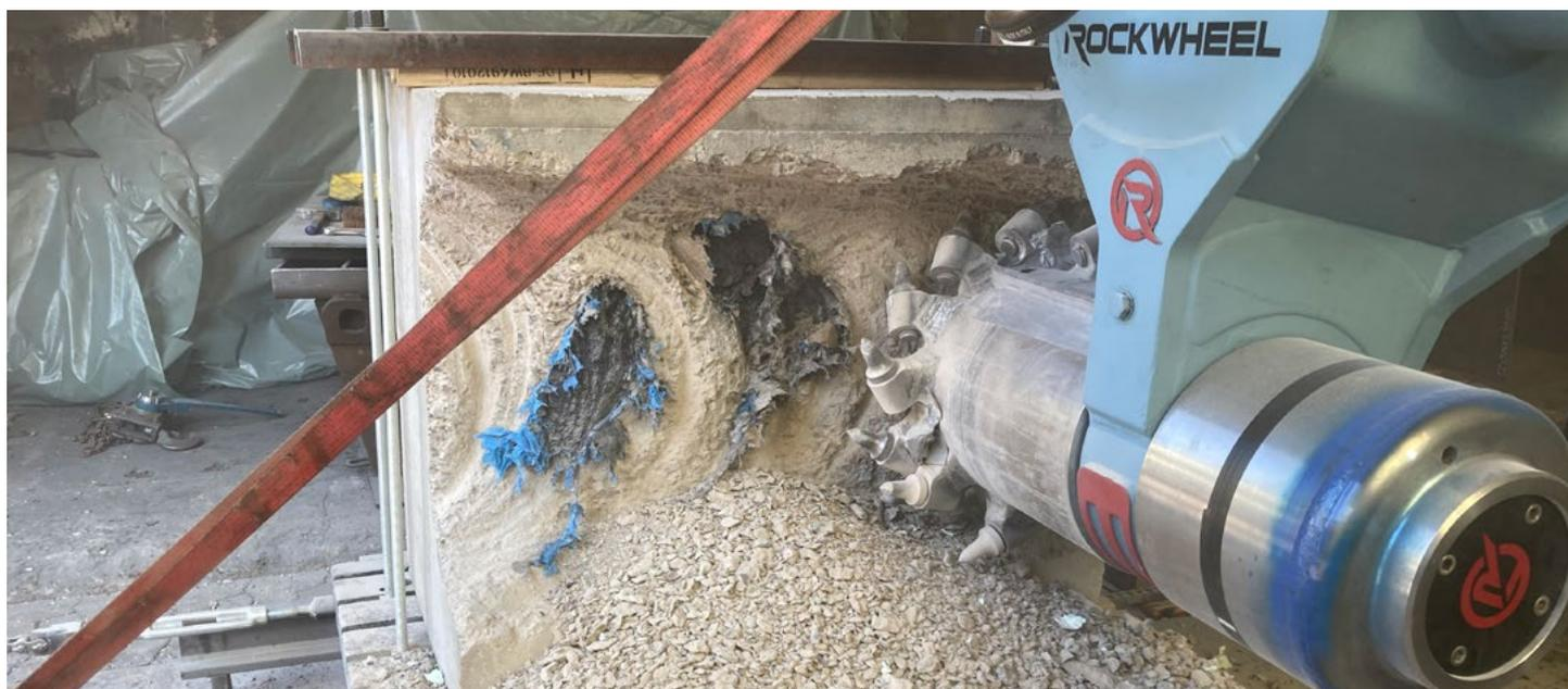
Schnitt durch einen Betonblock versetzt mit zu detektierenden Kohleeinschlüssen im Walze 4.0 Projekt.
