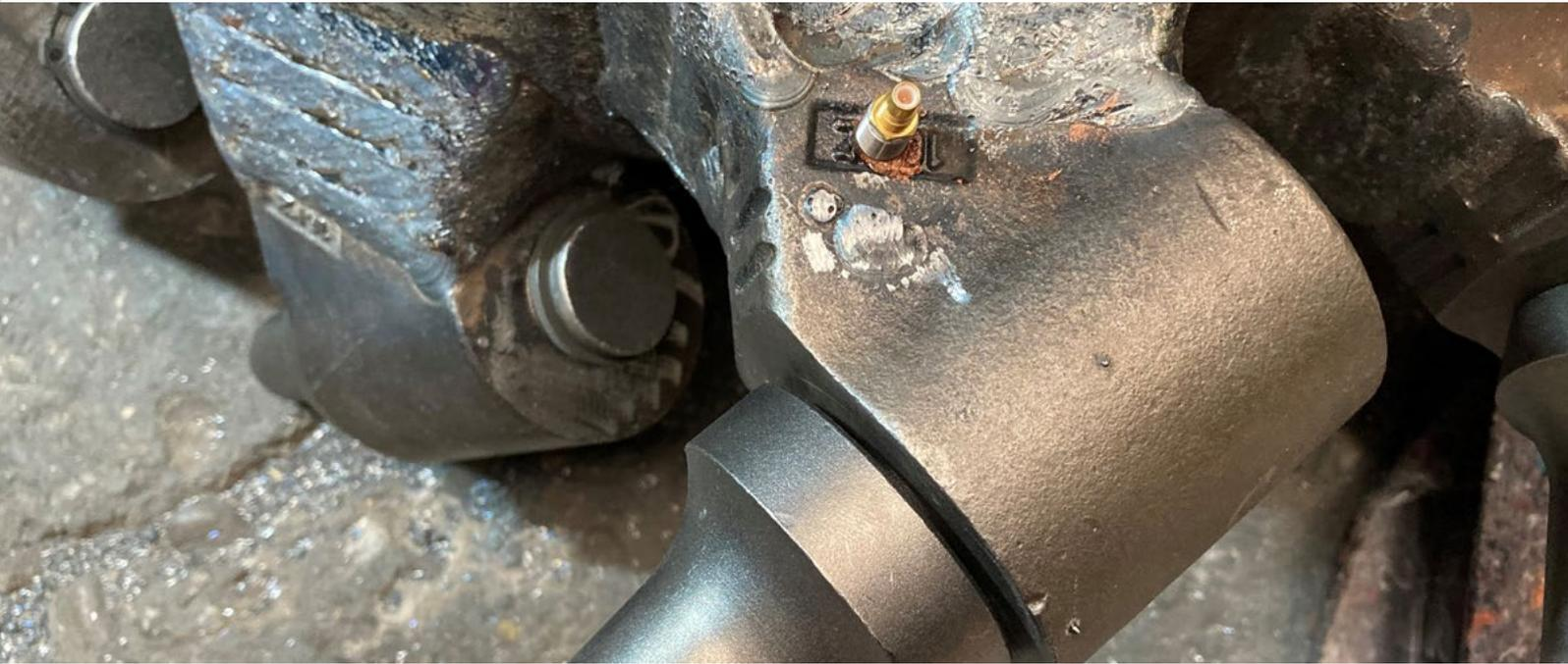
Installation von integrierter Messtechnik am Schneidmeißel.
